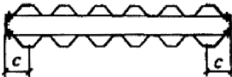
Рис. 15. Сечение трехслойной панели
