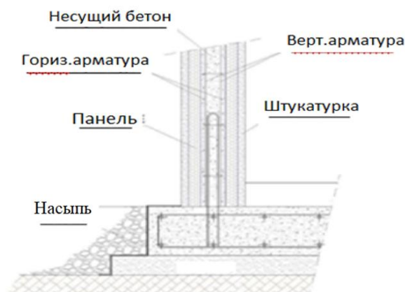
Рисунок 13.1 – Анкерное крепление панелей на фундамент
