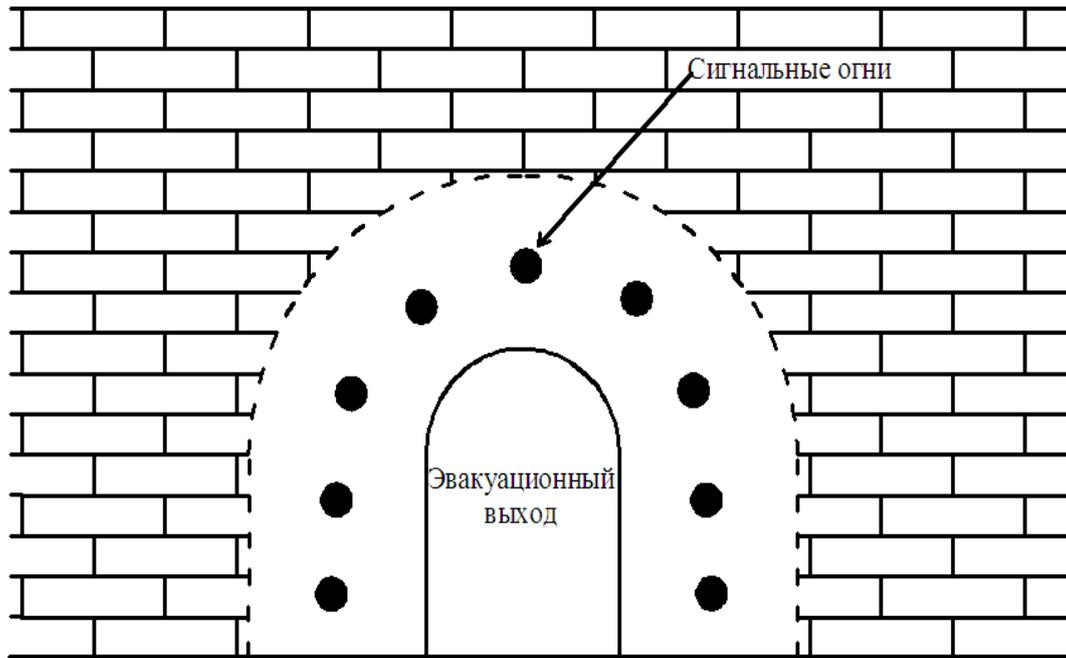
Рисунок Р.1 – Расположения сигнальных огней в автодорожном тоннеле
