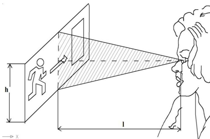
Рисунок Д.1 – Определение расстояния распознавания знака безопасности
