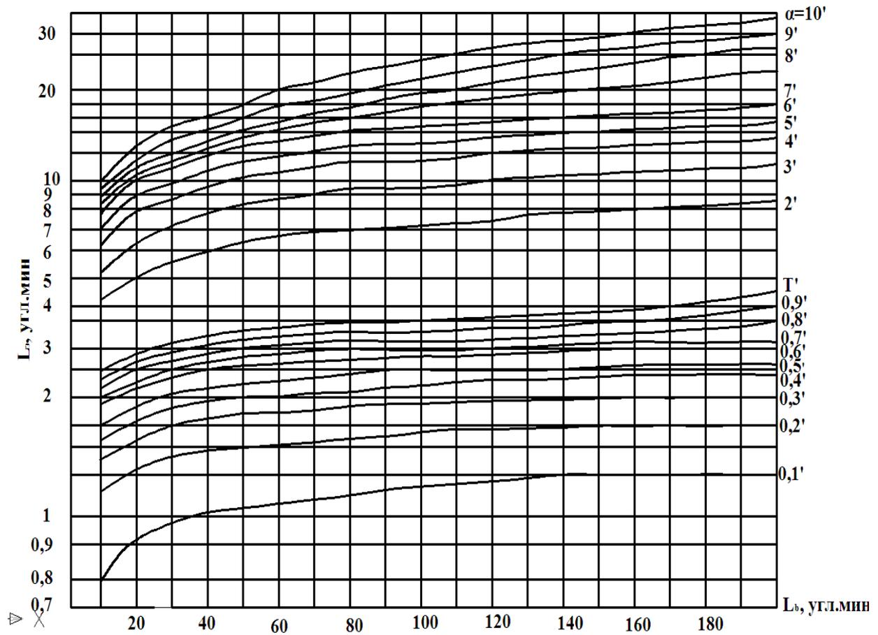
Рисунок Г.2 – Номограмма для определения эквивалентного размера протяженных объектов различения при расстояниях от глаза до объекта более 500 мм
