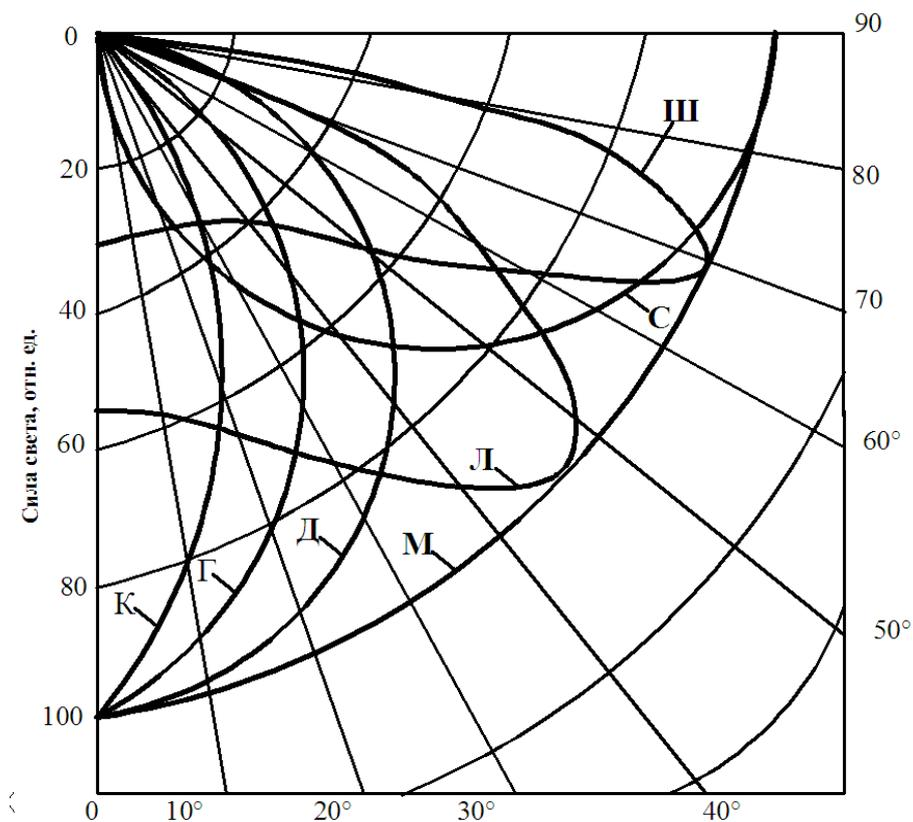
Рисунок Т.1 - Типы кривых силы света
