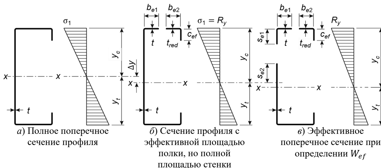
Рисунок 8.6 – Эффективное поперечное сечение (при \sigma_{сжм}=R_y ) для определения предельного изгибающего момента
