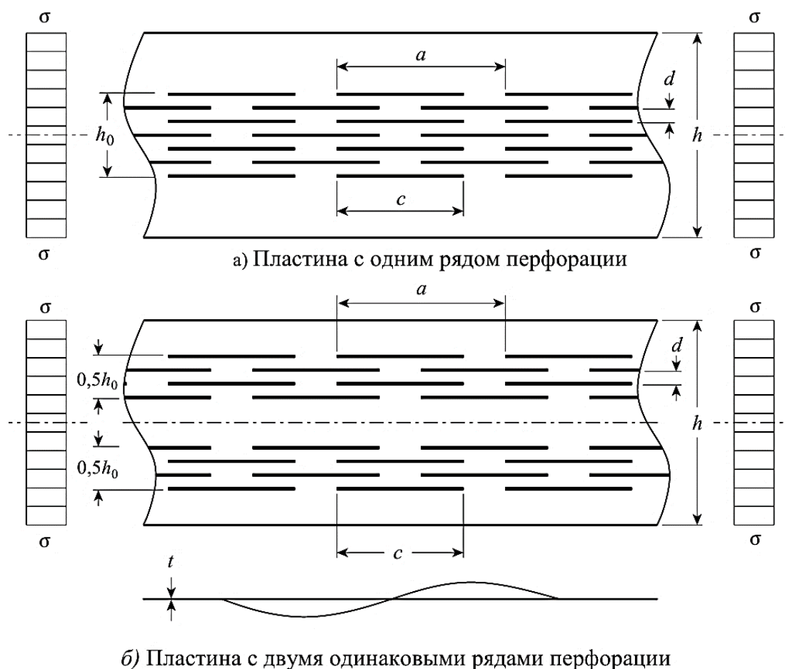
Рисунок 7.15 – Параметры щелевой перфорации термопрофилей
