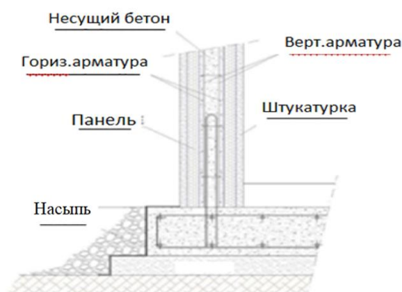
Рисунок 13.1 – Анкерное крепление панелей на фундамент
